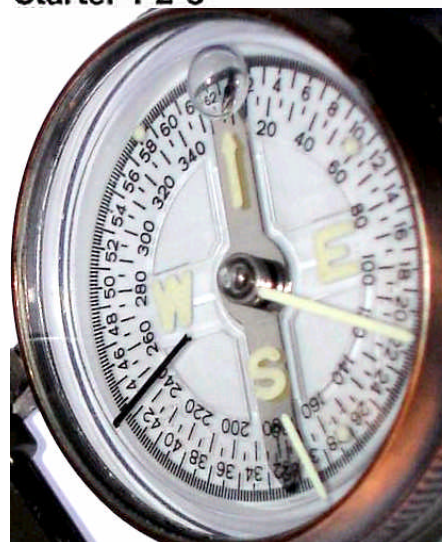
Figura 19: Brújulas. El instrumento superior permite medir direcciones (acimut-rumbo) con una precisión de 0.25 grados (15 minutos).
