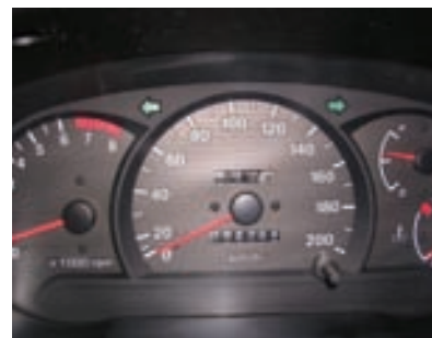
El velocímetro de un auto indica con buena aproximación la rapidez instantánea de este.
